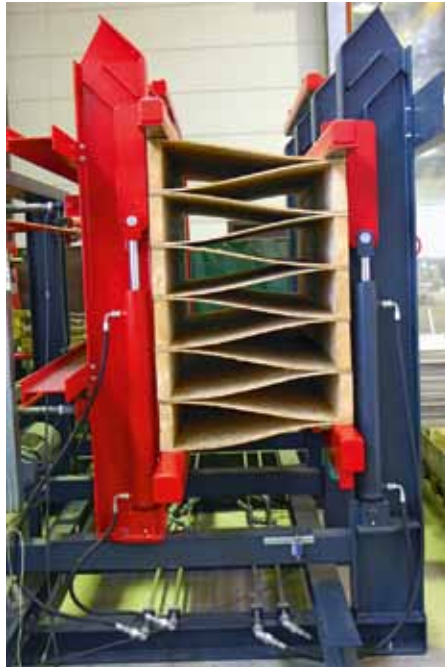
Presse für die Kielsteg-Produktion im Werk bei Minda: links die frisch befüllte Presse, rechts der Pressvorgang
