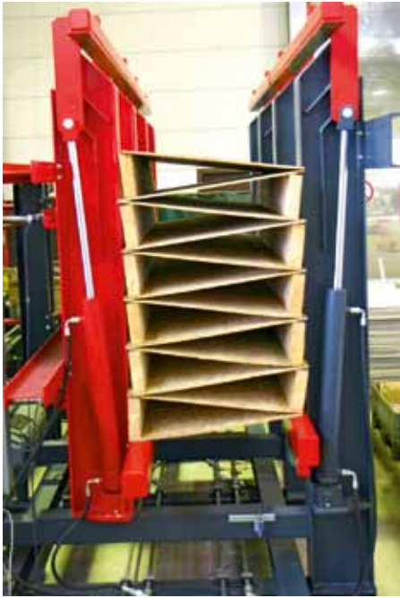
Presse für die Kielsteg-Produktion im Werk bei Minda: links die frisch befüllte Presse, rechts der Pressvorgang
