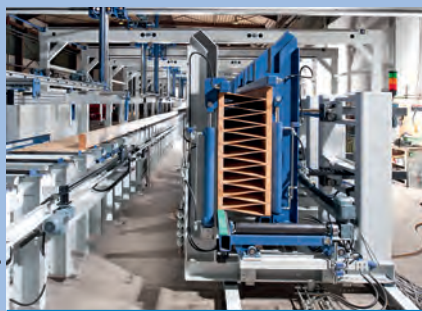
Bei minimalen Rüstzeiten können alle Kielsteg-Bauelemente von 228 bis 800 mm Bauhöhe gekrümmt oder gerade in einem Strang mit 35 Meter Länge produziert und in einem Arbeitsgang gehobelt und profiliert werden
